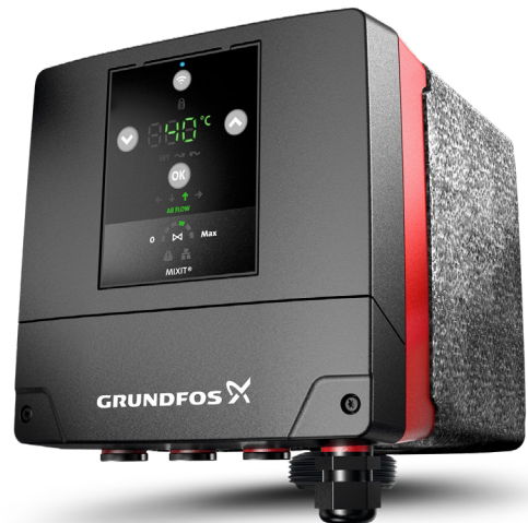
MIXIT-regelmodule met ingebouwde kogel- en terugslagklep, stappenmotor, temperatuur- en druksensoren en intelligente temperatuurregeling.
